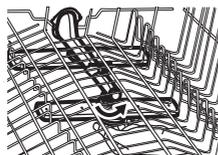
Inserire l'elemento di montaggio nel mulinello e fissarlo nel condotto ruotandolo in senso antiorario. Assicurarsi che l'elemento di montaggio si blocchi in posizione.
